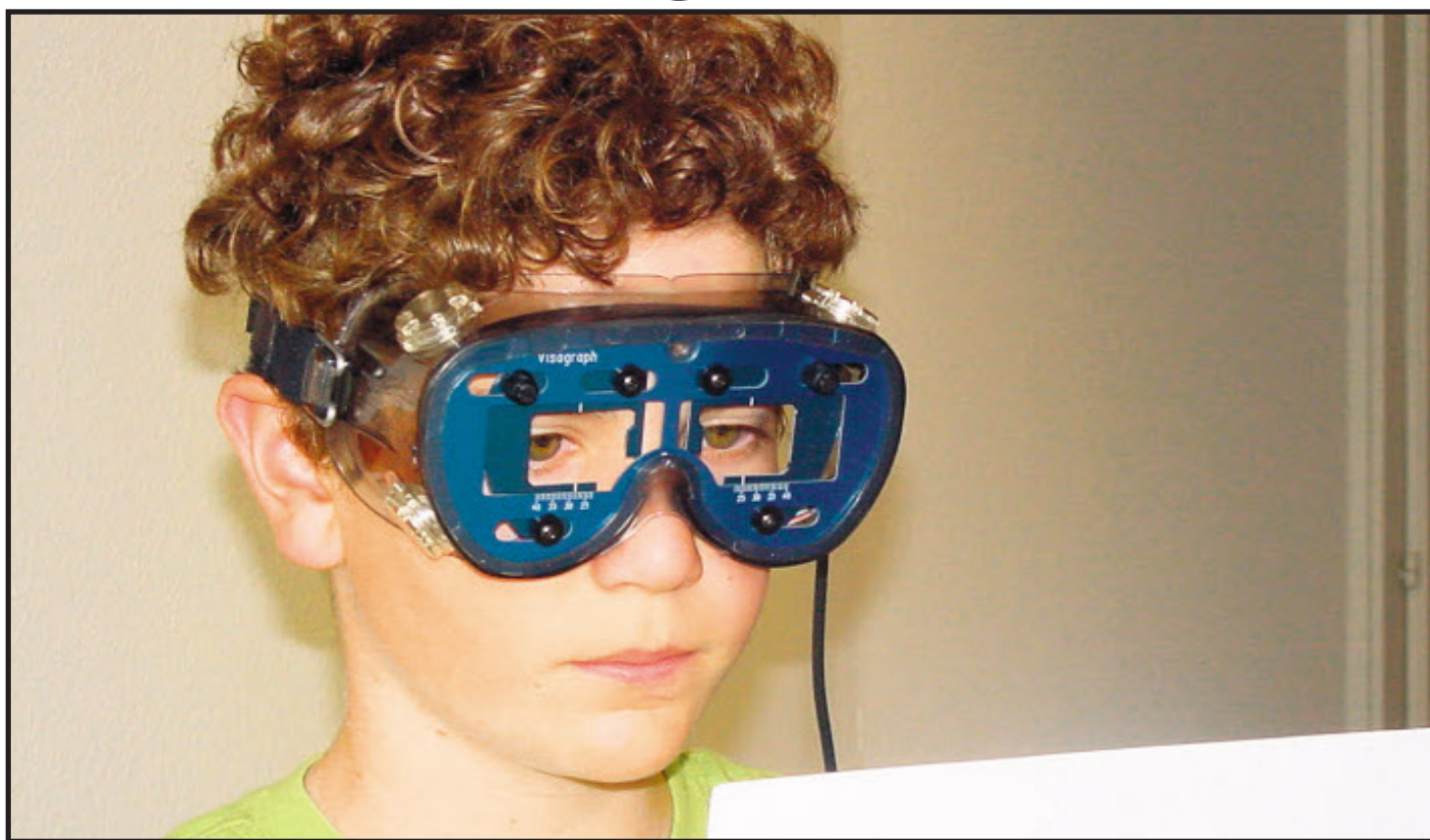
Lesetest mit dem Visagrafen: Infrarotsensoren im Innern der «Taucherbrille» messen jede noch so kleine Augenbewegung.
